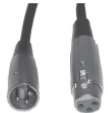
**Achtung:** Halten Sie sich für die Verlegung eigener Kabel an die Abbildungen 2 und 3. Benutzen Sie nicht die Masse am XLR-Stecker. Verbinden Sie den Massestift nicht mit der Abschirmung des Kabels und vermeiden Sie, dass die Abschirmung mit dem Gehäuse des XLR-Steckers in Kontakt kommt. Ein Kontakt der Abschirmung mit der Masse verursacht einen Kurzschluss und Störungen im Verhalten der Geräte.
